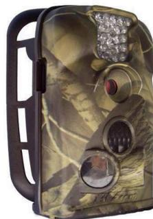
La cámara LTL-1342 es la evolución de la cámara LTL-1340, con excelentes mejoras, por mediación de una tarjeta SIM, esta cámara es capaz de enviar mensajes de texto cuando detecte movimiento a través de sus sensores, enviar MMS con las imágenes captadas o enviar correos electrónicos con imágenes y vídeos cuando se detecta un aviso de movimiento o indicando el estado de la batería. Además posee una tarjeta de 32Gb.
